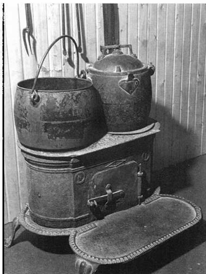
Stufa a legna per cucina di bordo su velieri del XIX secolo Collezione A. Cosulich (foto M. Lion)
